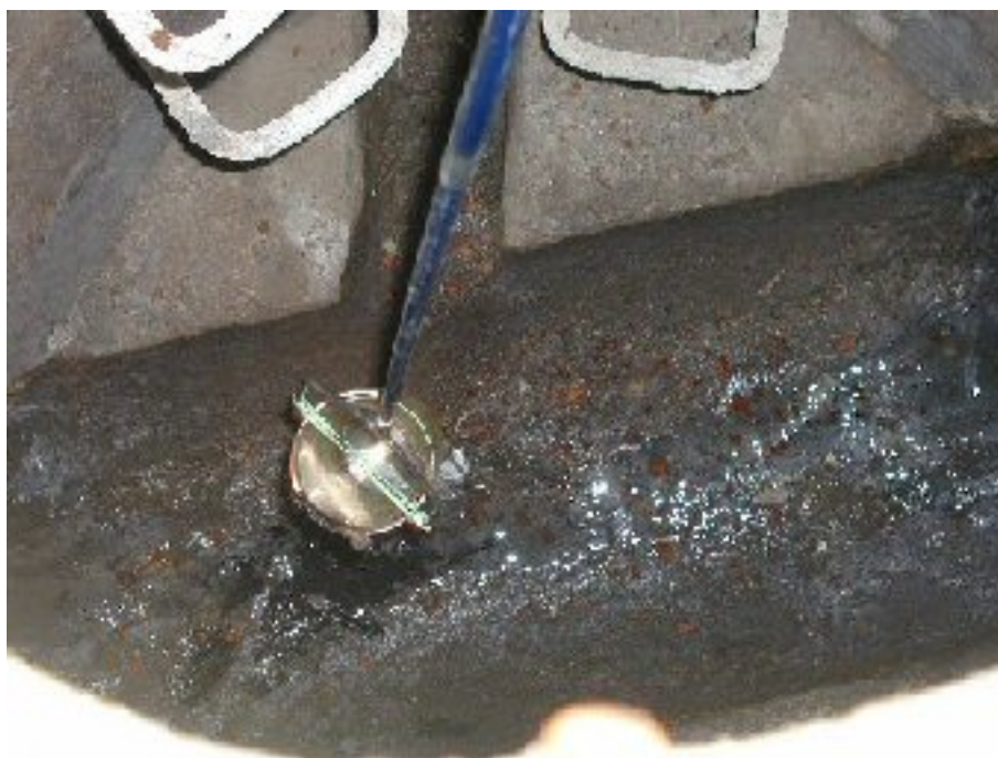
Figur 2.1 Prøvetagning af biofilm fra bunden af Brønd 900441 (Avedøreholmen) på Avedøre Holme. Til prøvetagningen blev anvendt et glas fastspændt på en teleskopstang, som kan skrabe sider og bund af kloakrøret.
