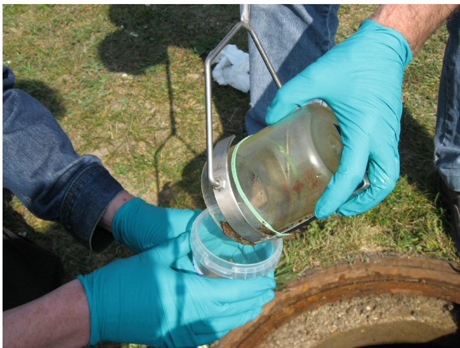
Figur 2.2 Prøvetagning af biofilm i Brønd 900610 (ved Avedøreværket) på Avedøre Holme. Biofilmen blev opsamlet i et plastikbæger.
