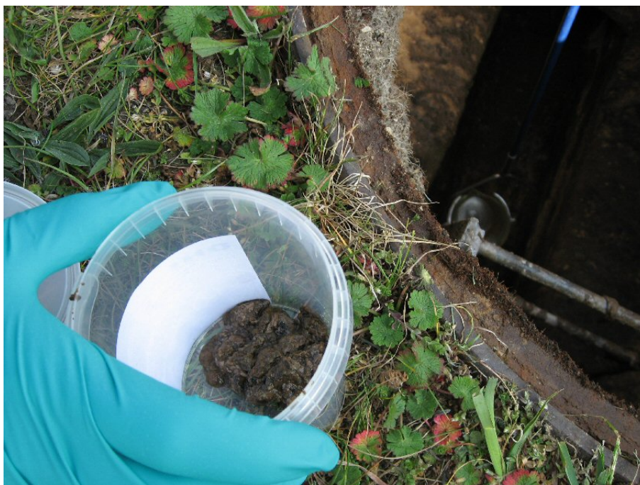
Figur 2.3 Prøvetagning af biofilm i Brønd 900610 (ved Avedøreværket) på Avedøre Holme.
