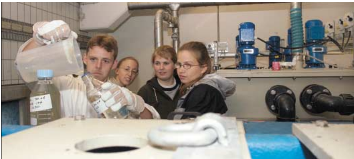
Ph.d.-studerende Kåre Press-Kristensen tager manuelt prøver direkte gennem dækslet øverst i de enkelte tanke. I baggrunden ses tre projektstuderende fra DTU.
